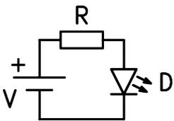
Esquema de un diodo LED polarizado con una resistencia que reduce la corriente para que no se queme.
