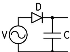
Esquema de un diodo rectificador que convierte la tensión alterna de la red eléctrica en tensión continua.
