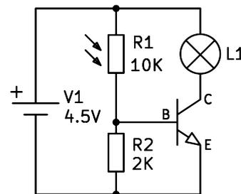
un amplificador de luz. Cuando se ilumina a la resistencia LDR, aumenta la corriente que la atraviesa. Esa corriente llega a la base del transistor y el transistor la amplifica a través del colector, encendiendo la lámpara conectada. Este es un
