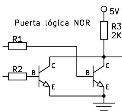
NOR formada a partir de transistores. Gracias al paralelo de los dos colectores, la salida solo tiene tensión alta cuando las dos entradas están a tensión baja.
